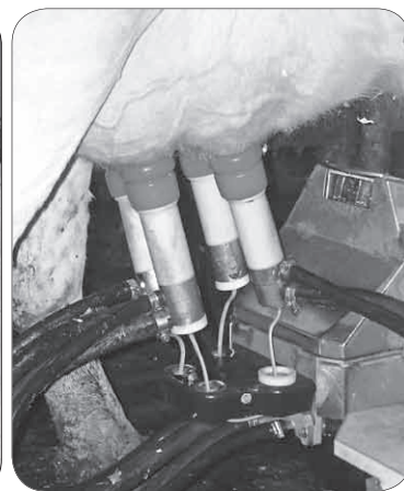
Mjölkroboten scannar in varje spene och ansluts var för sig innan mjölkningen startar.
